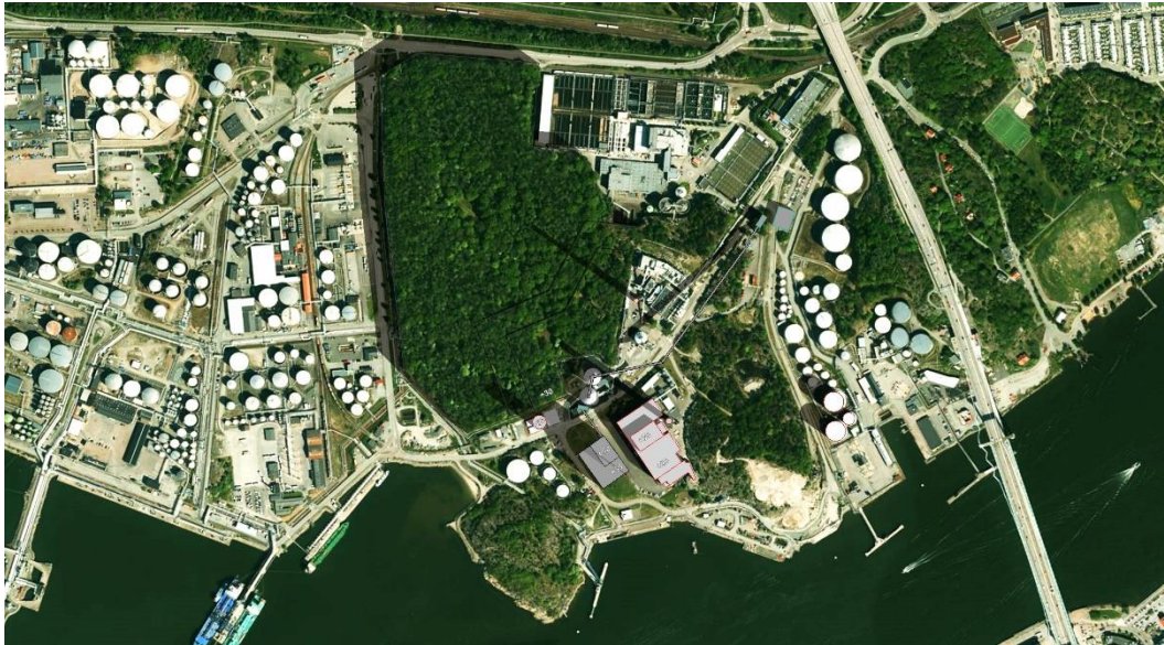
Figur 13 Toppvy 20 mars kl. 10. Vid denna tid på året står solen så högt att det på sin höjd är den allra sydligaste kanten av Rya skog som påverkas av skuggning från den planerade byggnaden för bioångpanna. De skuggpelare som når in i skogen som syns på bilden är från redan befintliga anläggningar.
