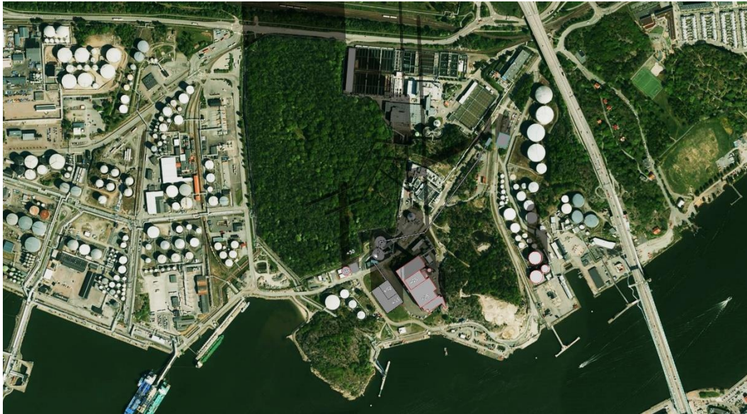
Figur 8 Toppvy 21 dec kl. 12. Denna visar att Rya skog inte skuggas av någon del från den planerade bioångpannan vid detta tillfälle. De två runda planerade silobyggnaderna för bränsle nära Rya skog kommer troligtvis flyttats till en placering längre söderut och därmed inte skugga skogen.
