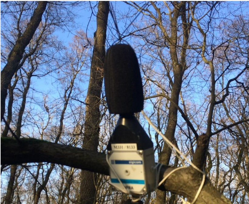
FIGUR 2: Exempel på mätpunkternas montering.
