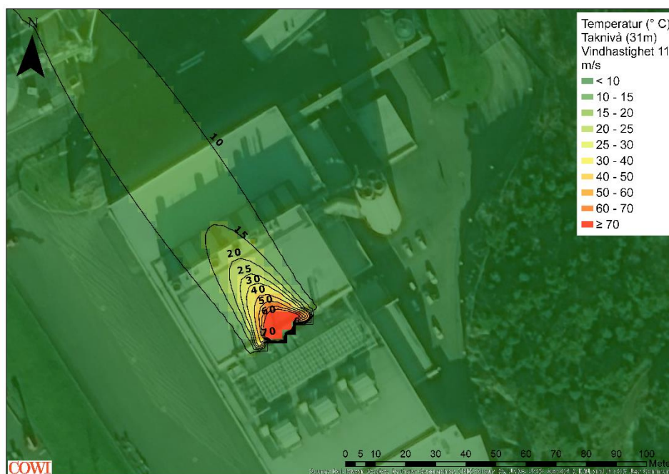
Figur 9. Lufttemperaturen på 31 meters höjd under separat elproduktion. Bilden redovisar en situation med en vindhastighet på 11 m/s (vid 10 meter). Omgivningsluften är 8 °C.
