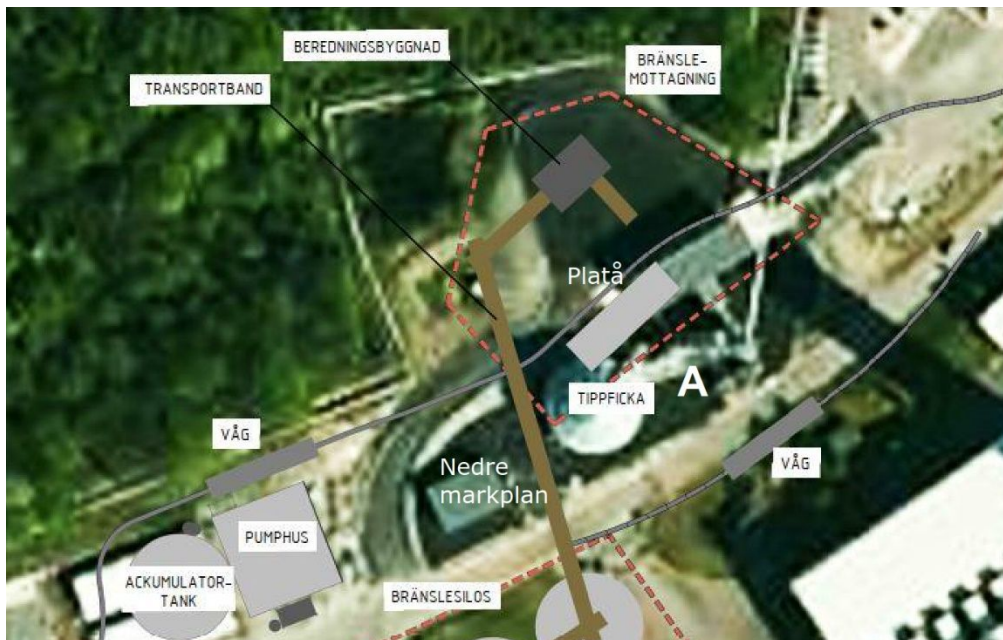
Figur 16. Exempellayout delområde A med tippficka och bränslemottagning (Göteborg Energi, 2021-01-23). Platån utökas till att omfatta allt inom röd sträckning.
